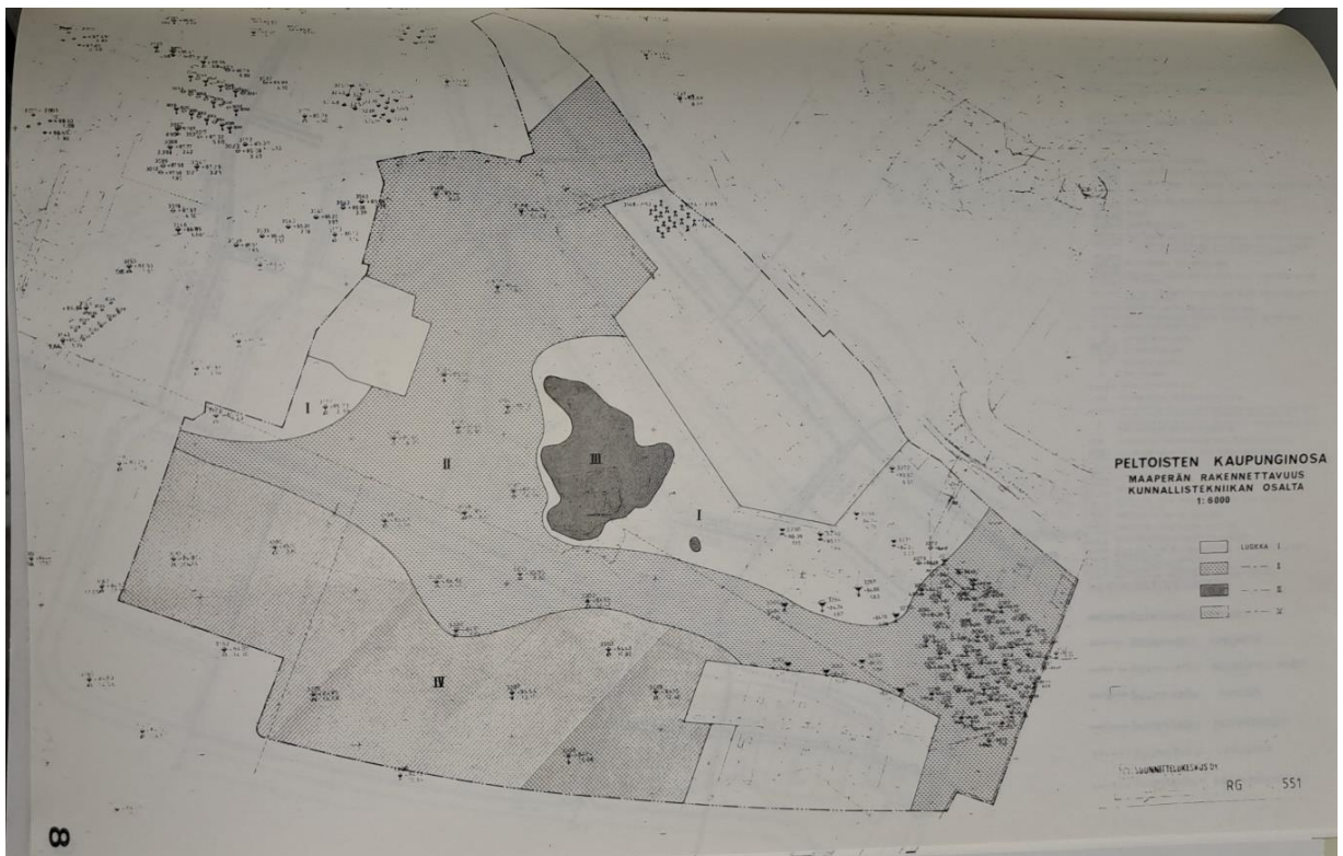
Kuva 28 – Kartta maaperän rakennettavuudesta kunnallistekniikan osalta
